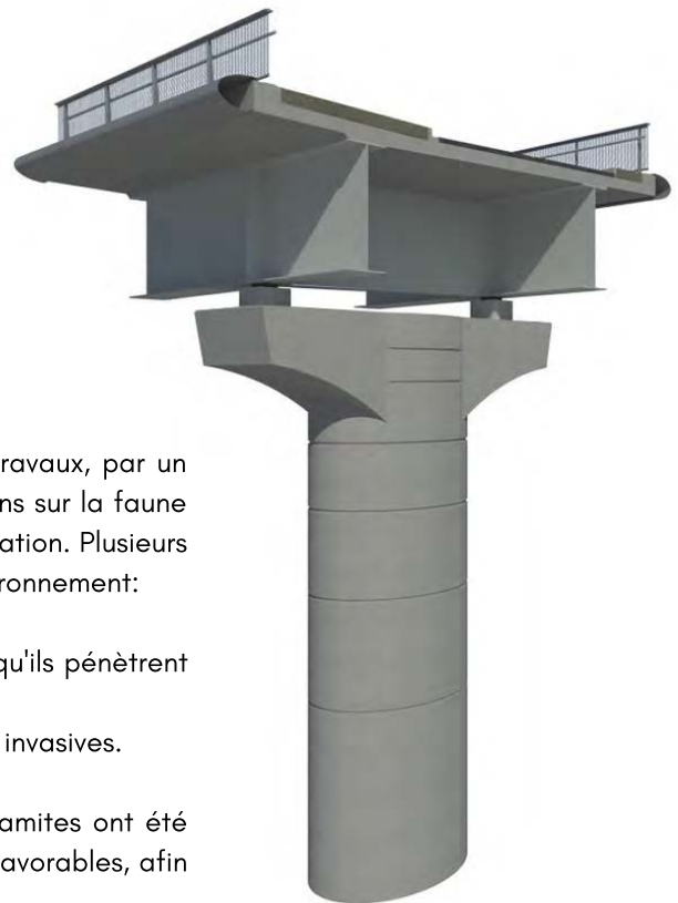
Fig. 02. piles du viaduc
